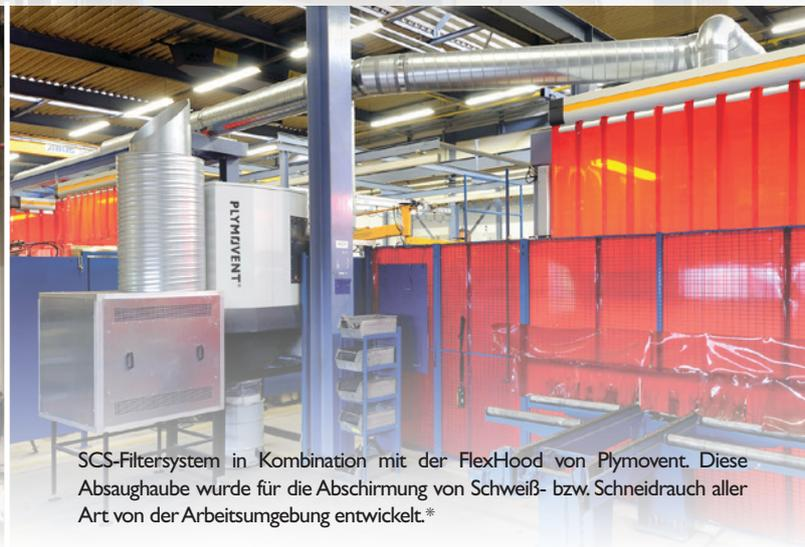
SCS-Filtersystem in Kombination mit der FlexHood von Plymovent. Diese Absaughaube wurde für die Abschirmung von Schweiß- bzw. Schneidrauch aller Art von der Arbeitsumgebung entwickelt.\*
