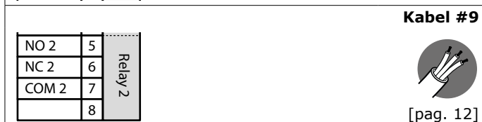
Fig. 4.29 Aansluiting van de relaisuitgangen
