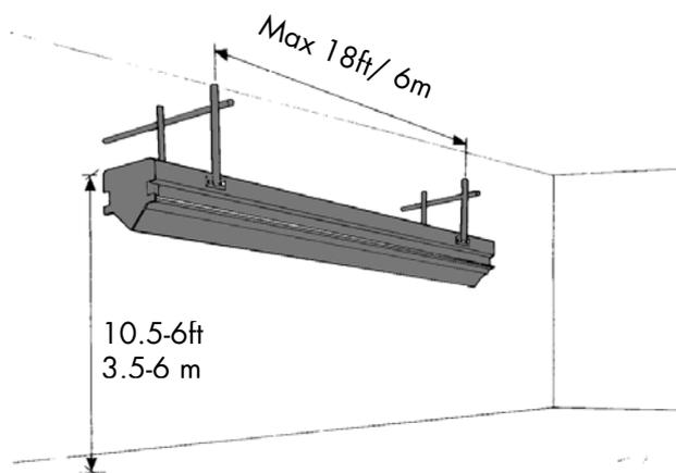
Die Bahn kann an Decke oder Wand montiert werden. Empf. Montagehöhe: 3,5 - 6m. Mindestabstand von Wand/Pfeiler: 0,2m
