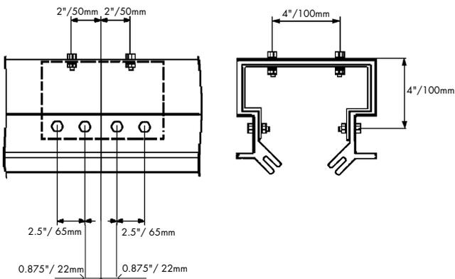
3. Ist die Bahn länger als 5,8m, sind die Bahnteile mit Verbindungsstücken, 8 Stck. M10x25 und MID Verschlussmuttern ineinander zu fügen. 2 weitere Aufhängerrohre sind für jeweils weitere 5,8m erforderlich.
