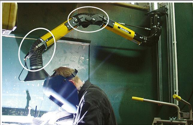
Außenseitig montierte Reibungsgelenke („ClearThru“-Design) für maximale Luftgeschwindigkeit, geringen Druckverlust und einen nur geringen Geräuschpegel.
