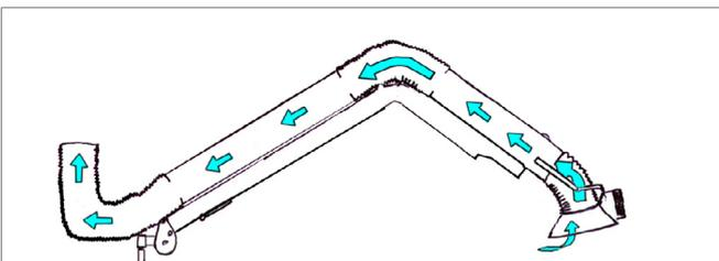
ClearThru-Ausführung für maximalen Luftstrom
