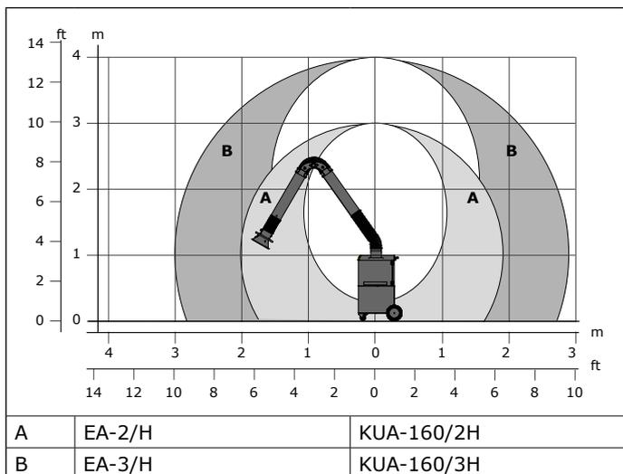
Abb. III Positionierung des Absaugarms
