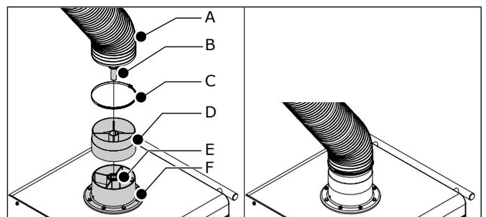
Abb. 4.2 Absaugarm an mobiler Filtereinheit
