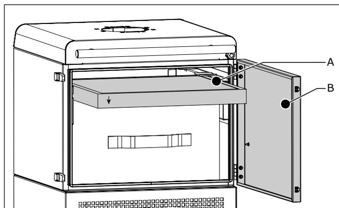
Abb. 6.1 Austausch der Vorfilter-Kassette
