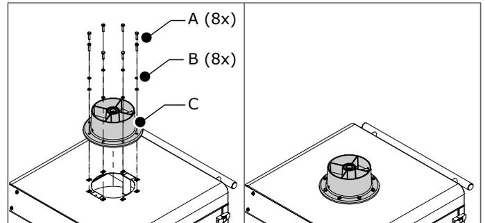
Abb. 4.1 Drehflansch
