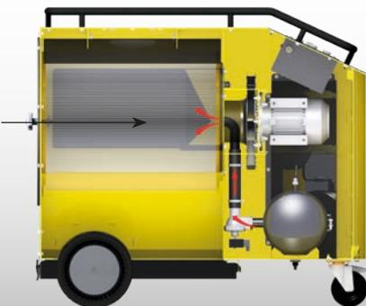
Ventilator 1,1kW (1.5 Hp) für leistungsstarke Absaugung
