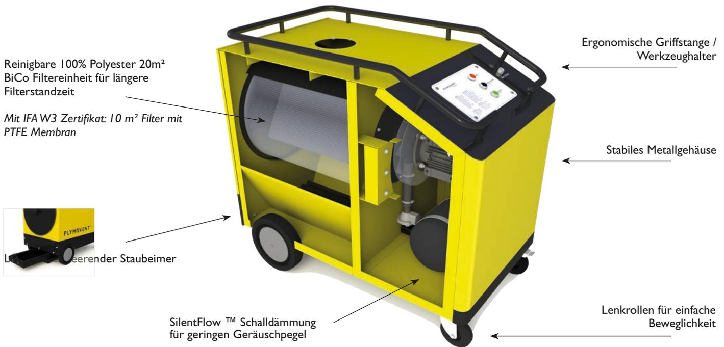
Selbstreinigender Ram-Air™ Druckluftimpuls ermöglicht effektivere Reinigung bei gleichzeitig längeren Filterstandzeiten und geringen Druckverlust
