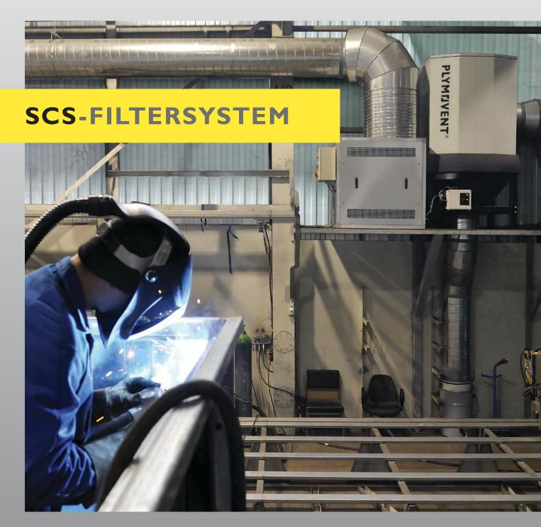
Selbstreinigendes Filtersystem zur effektiven Beseitigung von Schweißrauch
