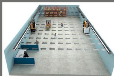
Sistema de Push/Pull paralelo con dos unidades de filtrado y dos ventiladores
