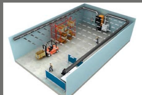
Sistema de Push/Pull en forma de U con una unidad de filtrado y un ventilador
