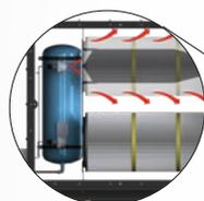
El amplificador de impulsos RamAir™ proporciona una limpieza superior para una vida más larga del cartucho de filtro y una menor caída de presiones
