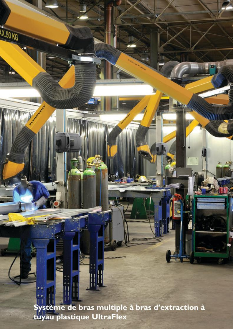
Systeme de bras multiple à bras d'extraction à tuyau plastique UltraFlex
