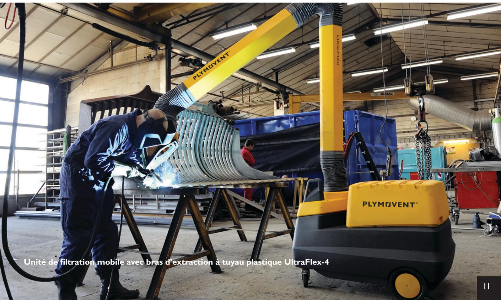
Unité de filtration mobile avec bras d'extraction à tuyau plastique UltraFlex-4
