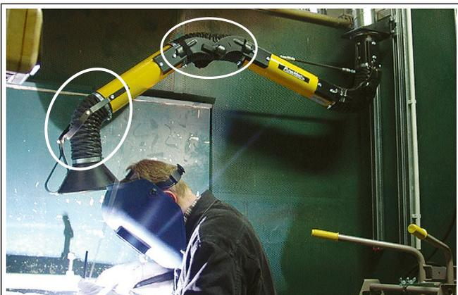
Articulations extérieures réglables (conception « ClearThru »), qui permettent une vitesse d'air maximale, une faible perte de charge et un faible niveau sonore
