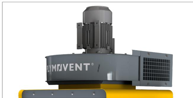
Le WallPro « PowerPlus » – qui combine le plus gros diamètre de bras avec un ventilateur supplémentaire puissant – est particulièrement adapté aux applications à rendement élevé impliquant de grandes quantités de fumée, tel que le soudage à l'arc avec fil fourré combiné à un processus de soudage automatisé
