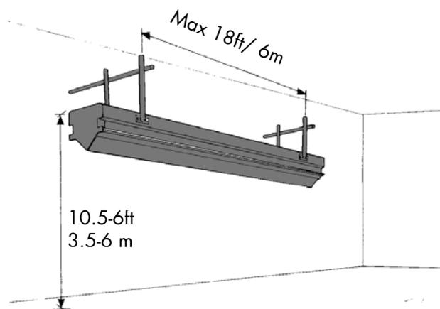
Le rail peut être monté soit au mur soit au plafond. La hauteur de montage recommandée est de 3,5 m à 6 m. La distance minimale du rail aux piliers ou au mur est de 0.2 m.
