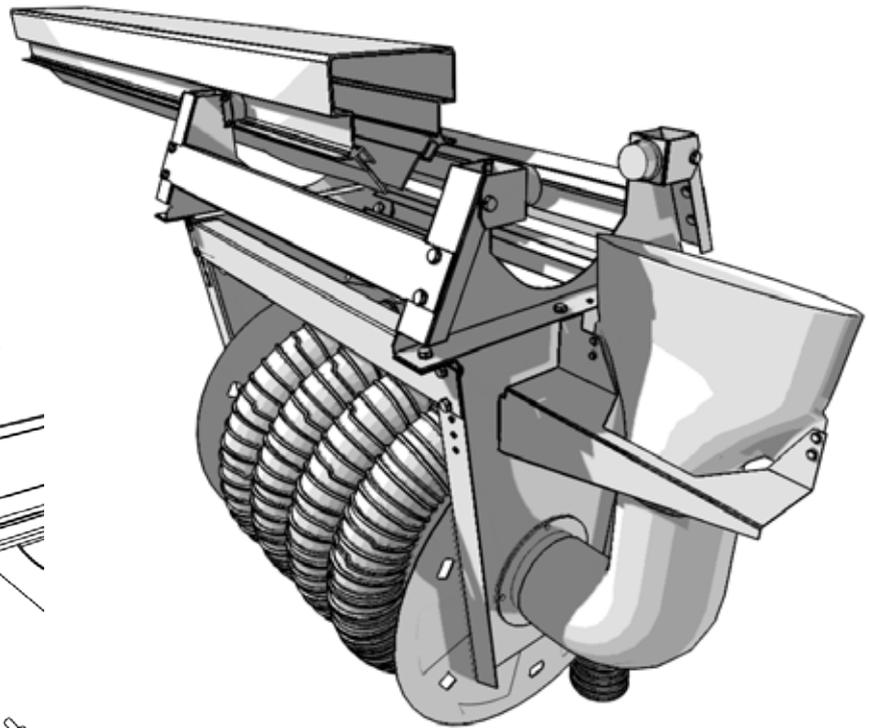
3. Si le rail a une longueur de 5,8 mètres assembler les éléments de rail à l'aide de bagues de fixation et de 8 boulons M10x25 munis d'écrous MID freinés. 2 fixations verticales supplémentaires sont requises par longueur de 5,8m.
