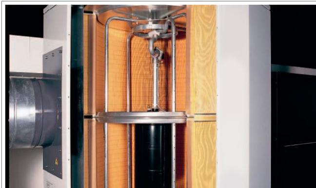
Décolmatage automatique à pilotage sectionnel des cartouches filtrantes par le système *RoboCleanPlus*
