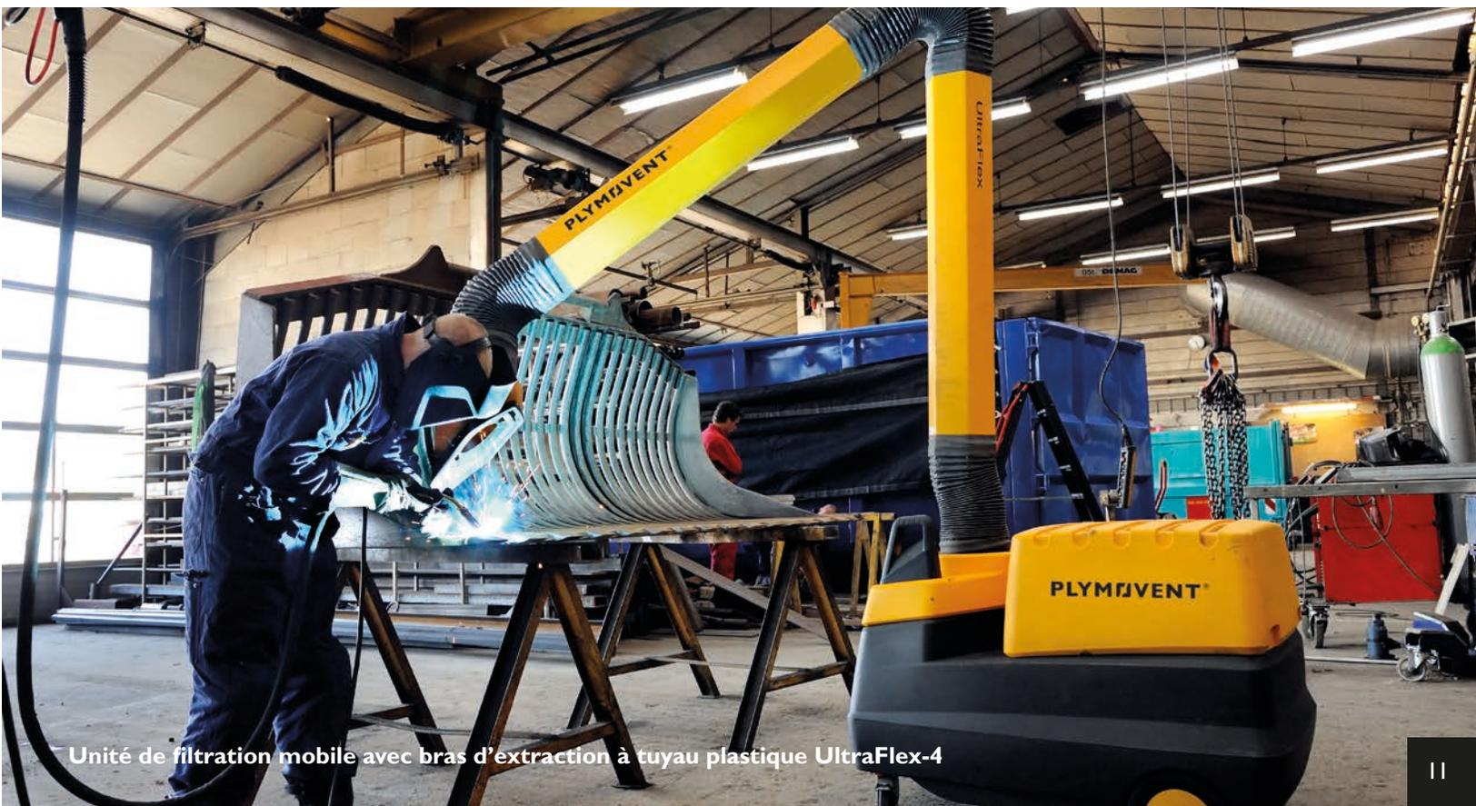
Unité de filtration mobile avec bras d'extraction à tuyau plastique UltraFlex-4
