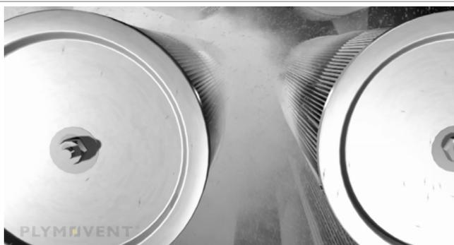
L' amplificateur d'impulsions RamAir™ : nettoyage individuel des cartouches filtrantes par des impulsions d'air comprimé
