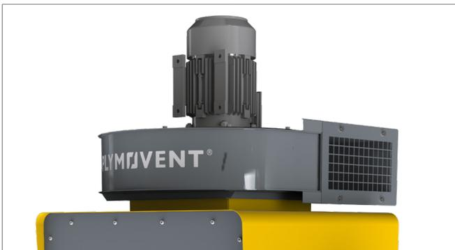
Le WallPro 2.0 Basic « PowerPlus » est particulièrement adapté aux applications à rendement élevé impliquant de grandes quantités de fumée, tel que le soudage à l'arc avec fil fourré combiné à un processus de soudage automatisé
