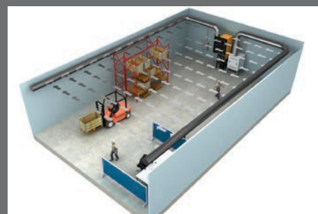
Système Push/Pull en forme de U avec 1 filtre et 1 ventilateur
