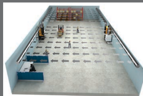
Système Push/Pull parallèle avec 2 filtres et 2 ventilateurs
