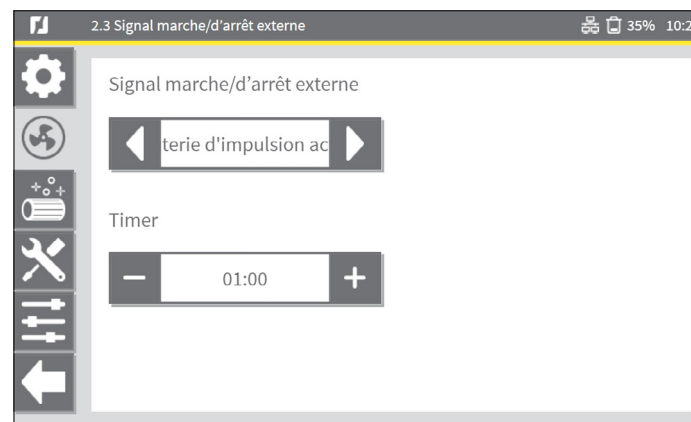
Fig. 4.14 Signal marche/arrêt externe : Minuterie d'impulsion activée
