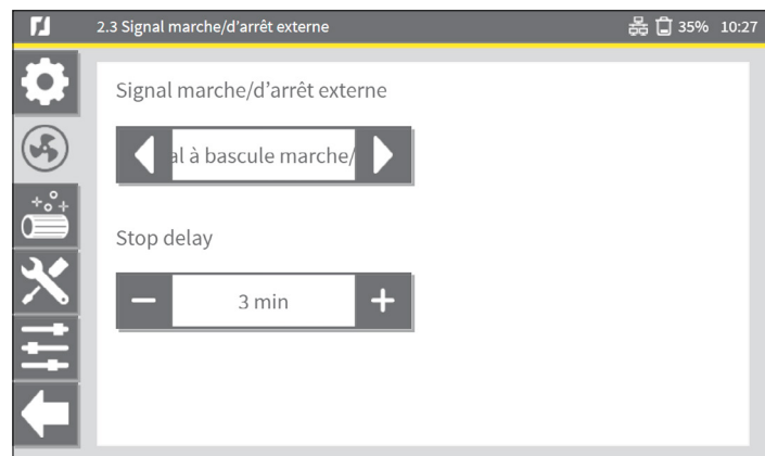
Fig. 4.12 Signal marche/arrêt externe : Signal à bascule marche/arrêt
