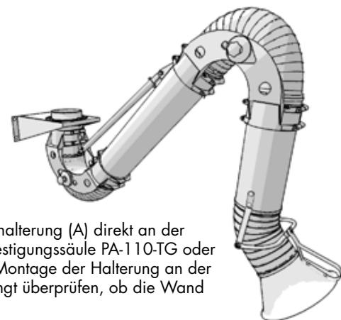
2. Befestigen Sie die Wandhalterung (A) direkt an der Wand oder an einer Befestigungssäule PA-110-TG oder PA-220-TG. Bei direkter Montage der Halterung an der Wand sollten Sie unbedingt überprüfen, ob die Wand ausreichend stabil ist.
