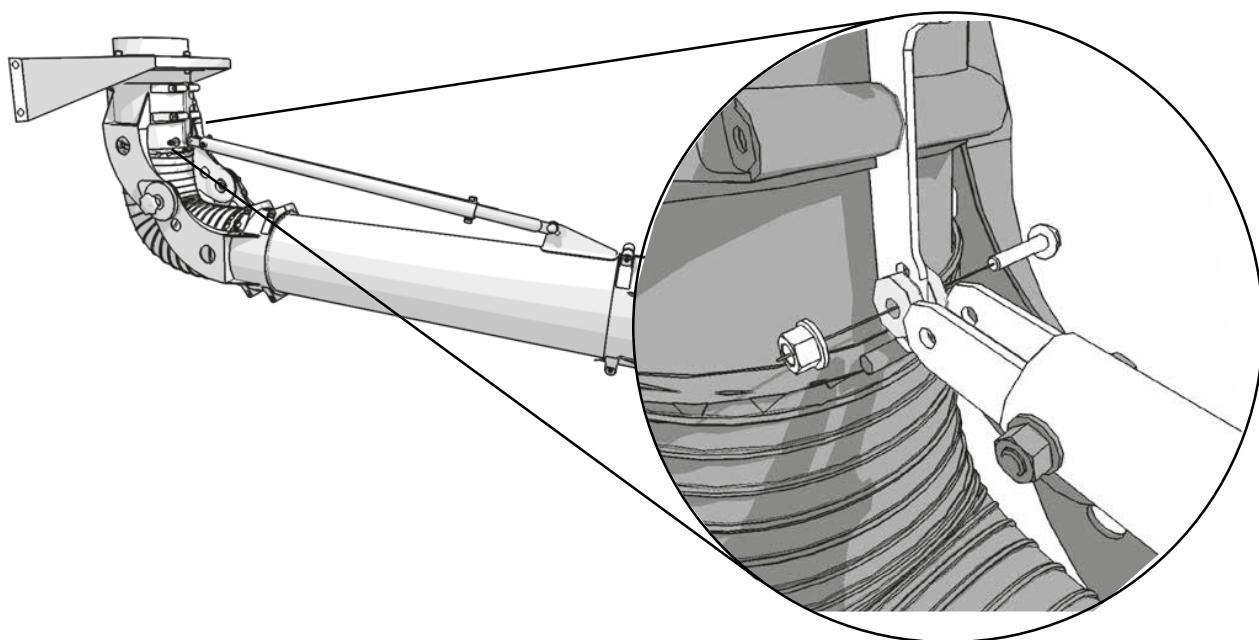
3. Ajustar las juntas de fricción a la tensión deseada.
